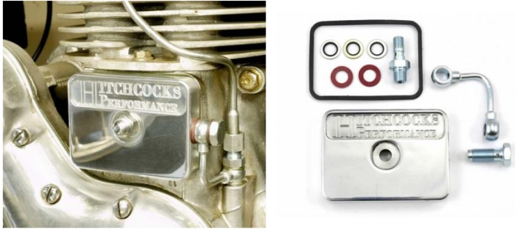
Fot.2. Zestaw oferowany przez Hitchcock's Motorcycles Ltd. przywracający zawór bezpieczeństwa w jego oryginalnym miejscu.
