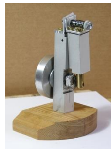
Rys.6. Zasada sterowania rozrzędem wykorzystująca wahliwy ruch sztywnego korbowodu.
