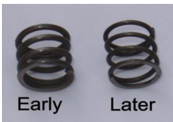
Fot.4. Dwa rodzaje sprężyn dociskających głowiczki pomp układu smarowania.
